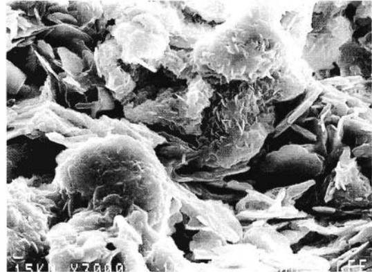
**Bild 5** REM-Aufnahmen (Sekundärelektronen) von der Oberfläche eines Bornitrid-Coatings
